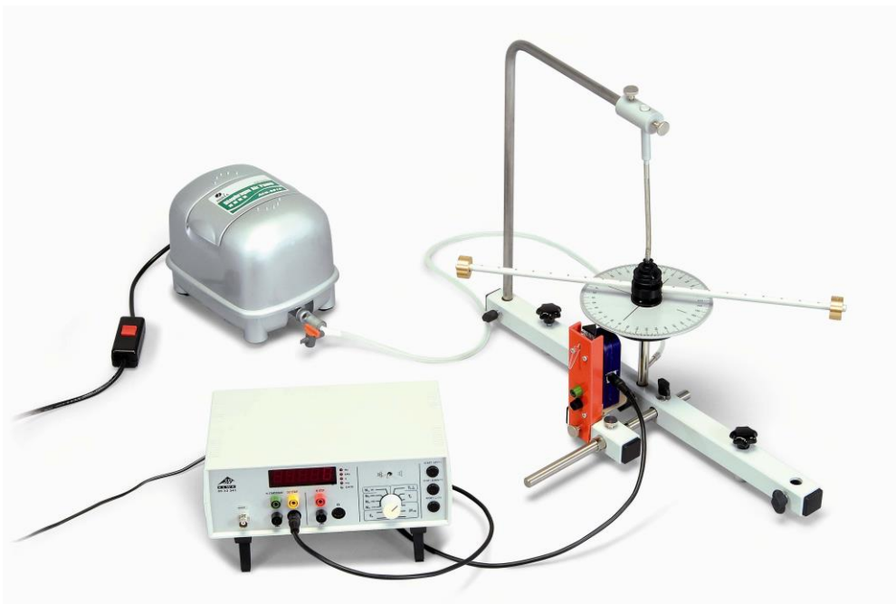
Fig. 1 : Agencement expérimental permettant de déterminer le moment d'inertie selon la méthode de la vibration de torsion
