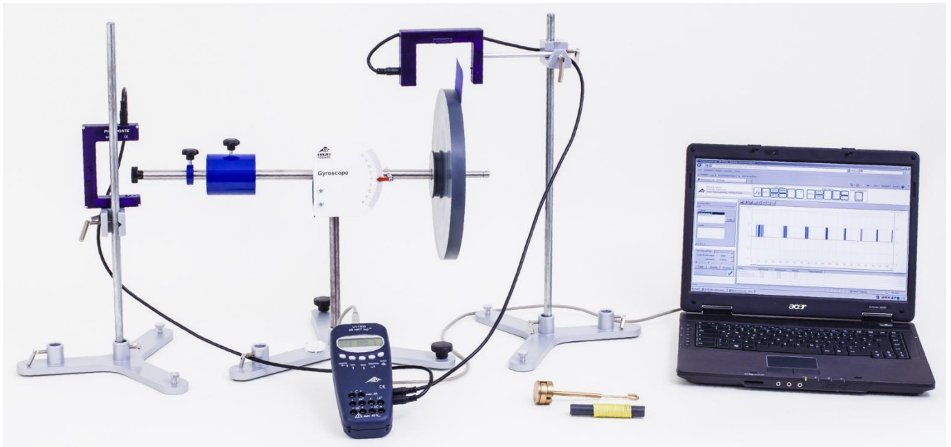
Fig. 1: Agencement de mesure pour la précession d'un gyroscope (sans masse supplémentaire)
