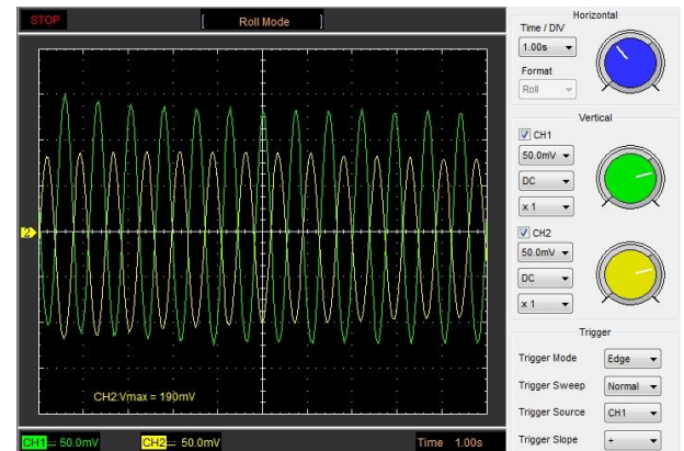
Fig. 8: Composants oscillants du pendule pesant simple lors d'un mouvement oscillatoire « perpendiculaire à la ligne bissectrice »
