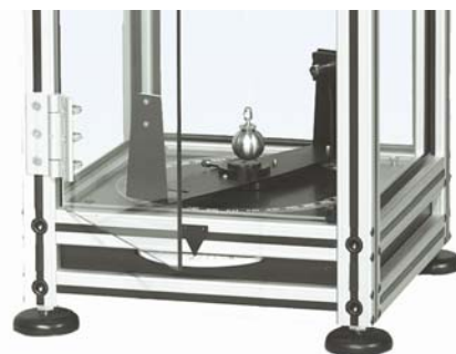
Fig. 3 Source lumineuse pour projection d'ombre, écran d'observation et disque gradué du pendule de Foucault
