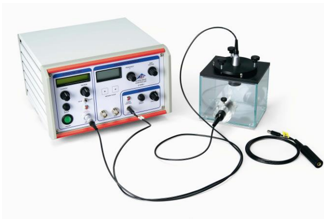
Fig. 3 : Dispositif de mesure permettant d'examiner la diffraction de la lumière sur un réseau de phase formé par des ondes ultrasonores dans un liquide
