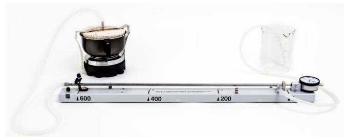
Fig. 12 : Montage avec un générateur de vapeur
