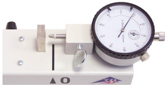
Fig. 5 : Introduire complètement le comparateur dans l'adaptateur et le fixer avec la vis à oreilles.
