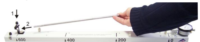
Fig. 6 : Fixer le palier fixe avec la vis moletée sur le repère 600 de l'appareil de dilatation thermique. Placer le tube en acier avec son extrémité ouverte dans le palier fixe.
