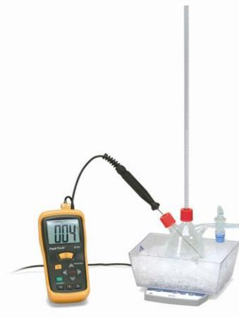
Fig. 2 : Appareillage expérimental permettant de déterminer la température pour le maximum de la densité de l'eau
