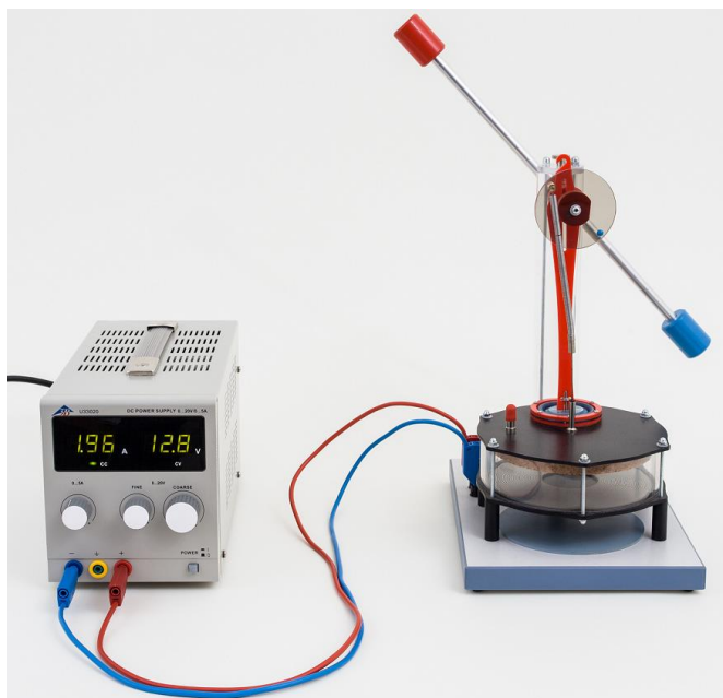
Fig. 5 : Montage pour une exploitation du moteur Stirling comme moteur thermique par chauffage électrique
