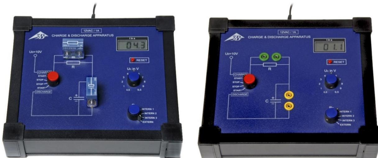
Fig. 1: Appareil de charge et de décharge en service avec une paire de résistances / condensateurs externe (à gauche) et interne (à droite).
