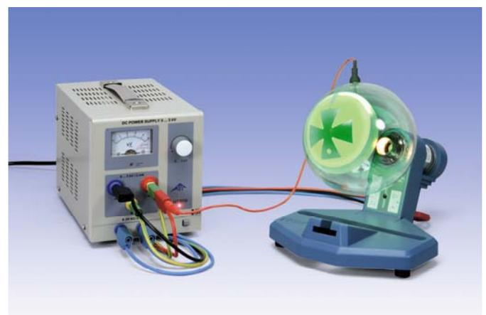
Fig. 2 Montage expérimental pour la démonstration de la propagation rectiligne d'électrons avec le tube à croix de Malte
