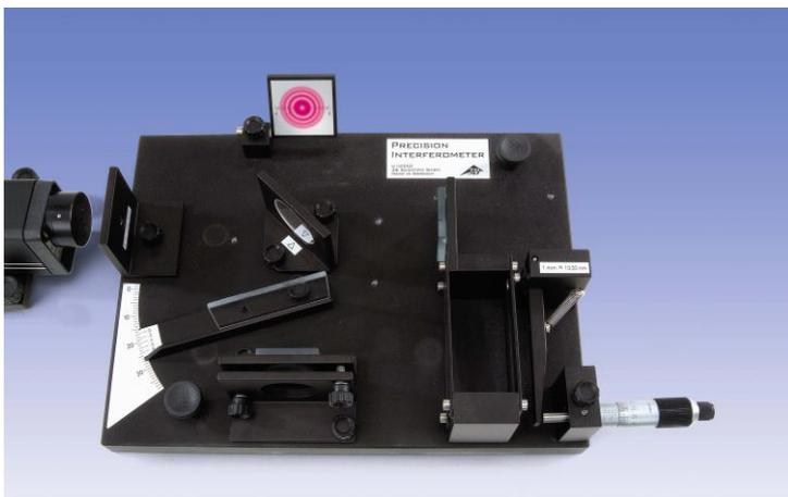
Fig. 1 : Dispositif de mesure permettant de déterminer l'indice de réfraction du verre en utilisant un interféromètre de Michelson
